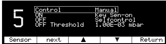
Figure 62: «Control Manual» display
